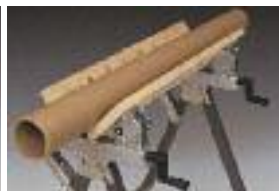
Se transforma in capra cu falcile setate la 45°
